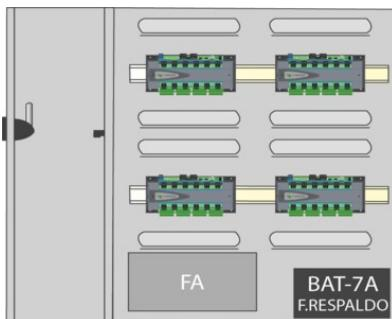
Tipo: Armario metálico con cierre por llave. Instalación: En superficie Fuente de Alimentación: Transformador reductor con rectificador, filtro y fusible. Bobinado Primario:230 Vca Bobinado Secundario:13,8Vcc Intensidad en salida: hasta 3,5A Permite batería adicional: Si Batería opcional: 12Vcc 7Ah Índice de protección: IP50
